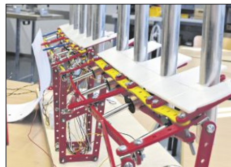
Elektromagneten schlagen die Töne an.
